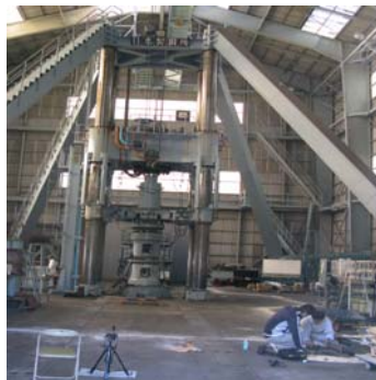
그림 5 - Large scale fatigue testing machine
