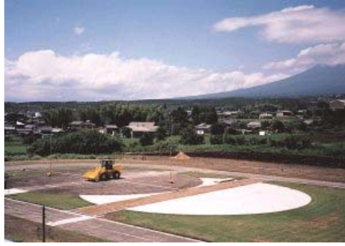
그림 4 - Sound power level measuring field
